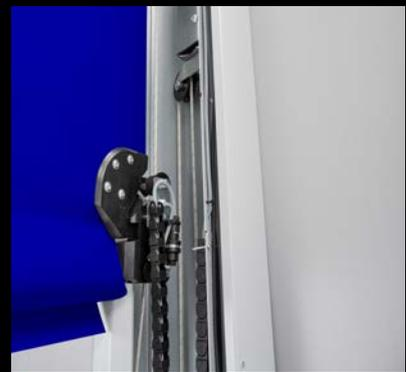
En caso de colisión, el borde de cierre puede deformarse en todas direcciones. Los cables pretensados garantizan una deformación controlada hasta que las conexiones de enclavamiento entre el extremo de la hoja de la puerta y las piezas guía también se aflojen. La hoja de la puerta se desliza entonces fuera de las guías del marco independientemente de la dirección.
