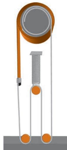
El sistema de carga de viento EFAFLEX garantiza una tensión permanente de la hoja. Perfecto cuando el viento o la presión negativa provocan corrientes de aire.
