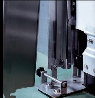
El mecanismo de bloqueo de las cubiertas de los marcos se desbloquea fácilmente y se pueden abrir y bloquear para facilitar la limpieza. De este modo, se puede acceder fácilmente a todo el interior con el chorro de vapor.
