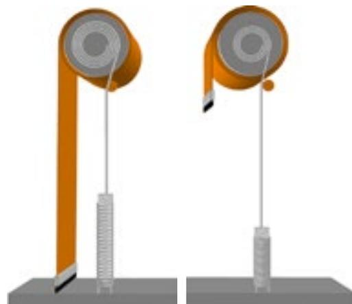
Los muelles de tracción se instalan en los marcos laterales y se conectan directamente al eje de accionamiento mediante correas de alta resistencia. Los muelles se tensan en la posición de "puerta cerrada" (fig. izquierda) y se liberan en la posición de "puerta abierta" (fig. derecha).
